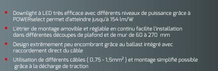
Le guide de lumière PMMA non jaunissant assure une puissance lumineuse
