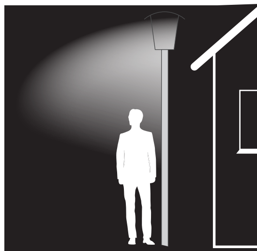
Orientation de la lumière grâce à un culot rotatif avec fonction d'encliquetage
