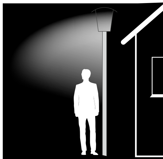
Drehbarer Sockel ermöglicht Lichtlenkung
