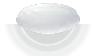
Erfassungsbereich des Sensors: Halbkugelförmig in Leuchtrichtung
