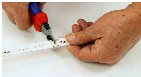
Individuell teilbar alle 10 cm; Beidseitig zwei einzelne Anschlussklemmen.
