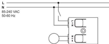
LED-Dimmer zum komfortablen Bedienen von Leuchten via CASAMBI App mittels Phasenabschnittssignal (max. 150W)
